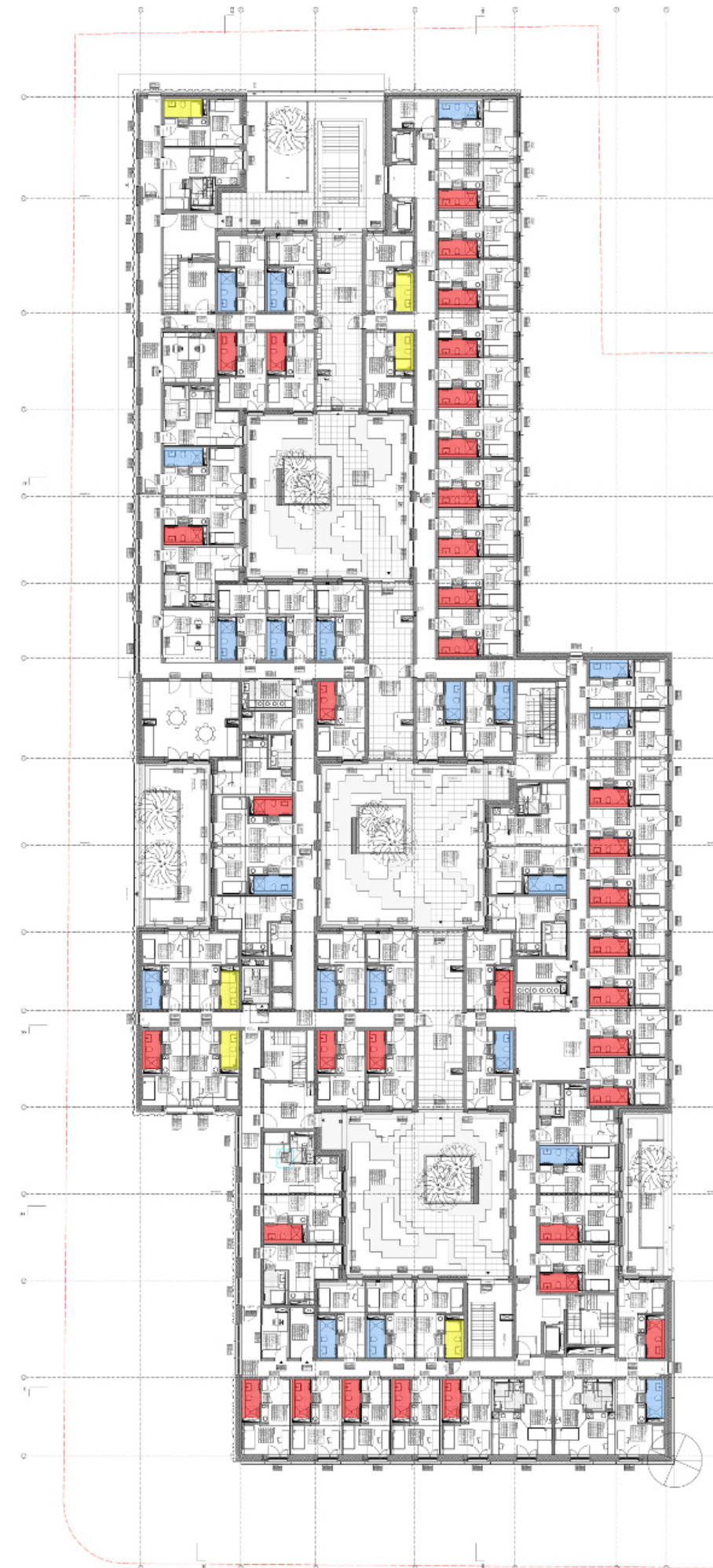
Gebäudeteil C Studentenwohnen mit farblich markierten Fertigbauelemente der Nasszellen.
